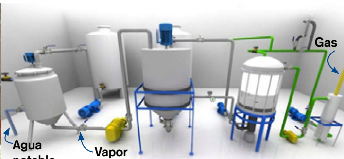
Figura 51. Sistema de distribución de tuberías de agua de consumo con identificación de colores
